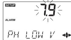
Wenn der pH-Tiefalarm aktiviert ist, wird "PH LOW VALUE" am unteren Rand des LCD angezeigt. Der aktuell eingestellte Tiefstwert (editierbar) wird blinkend angezeigt.
