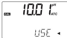
5. Beide Elektroden mit Puffer pH 10,01 im Spülbecher spülen und dann in den Kalibrierbecher mit Puffer pH 10,01 tauchen.
