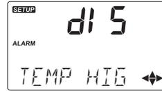
"TEMP HIGH" wird am unteren Rand des LCD angezeigt,
