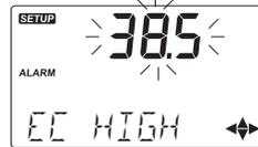
Wenn der Salinitäts-Hochalarm aktiviert ist, wird "EC HIGH VALUE" am unteren Rand des LCD angezeigt.
