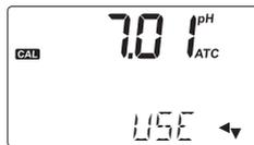
3. Beide Elektroden entweder in pH 7,01 pH oder 10,01 Puffer tauchen und leicht bewegen, um eventuelle Luftblasen zu entfernen.
