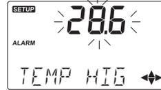
Wenn der Temperatur-Hochalarm aktiviert ist, wird "TEMP HIGH VALUE" am unteren Rand des LCD angezeigt.
