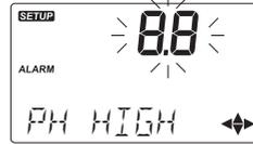
Wenn der pH-Hochalarm aktiviert ist, wird "PH HIGH VALUE" am unteren Rand des LCD angezeigt. Der aktuell eingestellte Höchstwert (editierbar) wird blinkend angezeigt.
