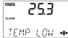
Wenn der Temperatur-Tiefalarm aktiviert ist, wird "TEMP LOW VALUE" am unteren Rand des LCD angezeigt.
