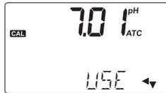
3. Beide Elektroden in Puffer pH 7,01 tauchen.
