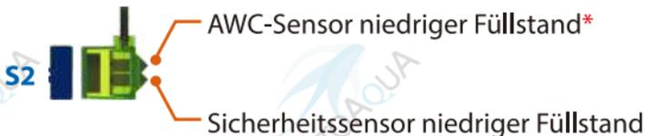
\*Der Hochfüllstand-ATO/AWC-Sensor (S1) muss mindestens 6 mm höher sein als der Niedrigfüllstand-AWC-Sensor (S2), sonst funktioniert der Smart AWC Lite nicht zuverlässig.
