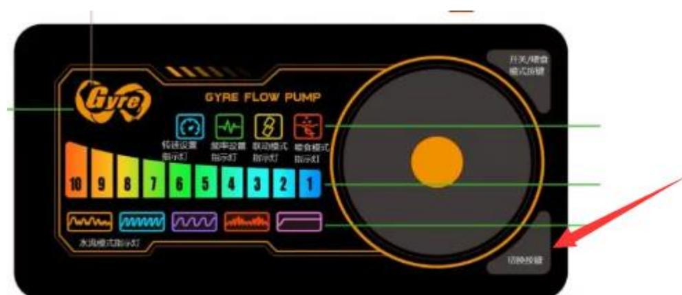
Une fois le bon modèle déterminé à l'étape 2) ou 3), il est indispensable d'éteindre puis de rallumer le contrôleur pour confirmer la sélection du modèle. Si, lors du redémarrage du contrôleur, le logo **Gyre** clignote deux fois, cela correspond au modèle 308 ; s'il clignote quatre fois, cela correspond au modèle 316
